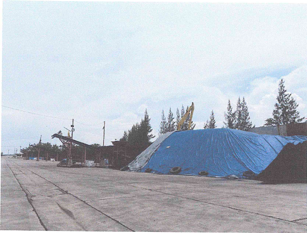
ภาพที่ 1 มีการใช้ผ้าใบปกคลุมกองกะลาปาล์มในส่วนที่ยังไม่ได้ใช้งานเพื่อทำให้เกิดความชื้นและป้องกันปัญหาการเกิดฝุ่นละออง
